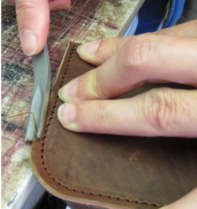
Abb. 22: Bearbeitung der Kanten mit einem Kantenzieher
