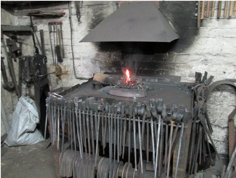
Abb. 45: Schmiedefeuher und eisenverarbeitende Werkzeuge
