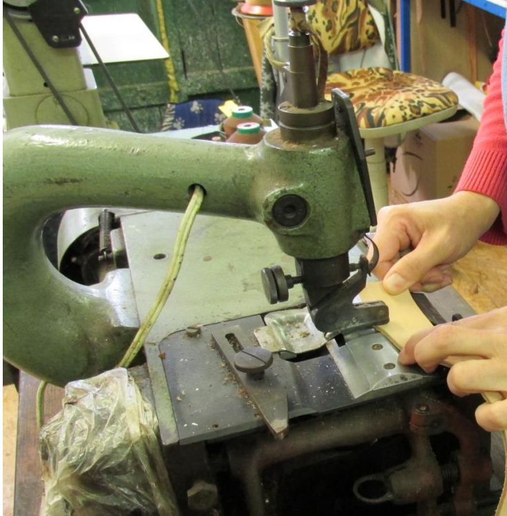
Abb. 21: Ausdünnen der Kanten auf der Schärmaschine
